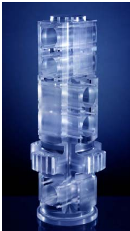
Blok křemene, ve kterém jsou uloženy gyroskopy. V horní části jsou patrné čtyři válcové tunely připravené pro uložení gyroskopů. Výška bloku je 53 cm. Foto: GPB, Stanford University.
