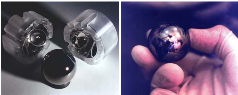
Nalevo: Rotor gyroskopu s oběma polokulovými pouzdry. Foto Don Halley. Napravo: Rotor gyroskopu v ruce. Foto GPB, Stanford University.
