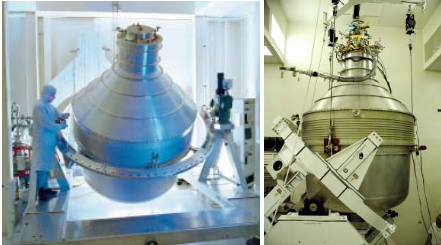
Dewarova nádoba – hlavní část družice obsahující kapalné hélium. Foto nalevo: Russ Underwood (Lockheed Martin Corporation) Foto napravo: Russ Leese (Stanford University)
